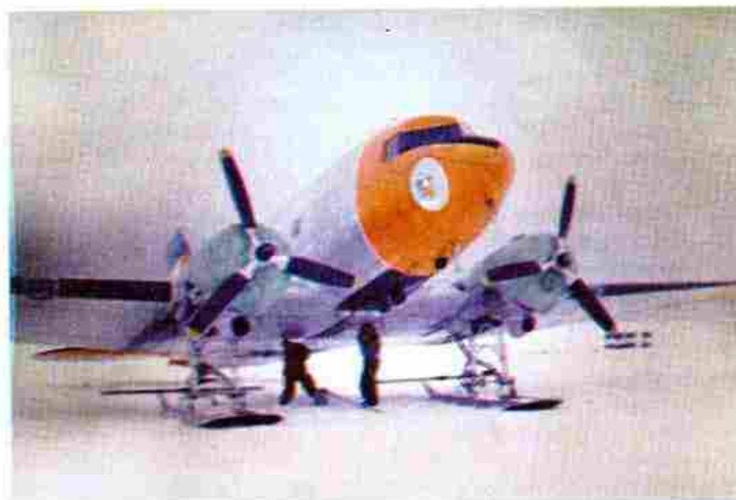
Retirando las tapas ventrales de combustible del CTA-12 para colocarle los soportes de dos nuevos "jatos".
