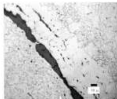
Figura 10: inclusiones de silicato de Mn y tamaño de grano heterogéneo. Figure 10: Mn silicate inclusions and heterogeneous grain size.
