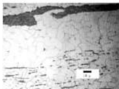
Figura 6: zona cercana al borde del clavo con bajo contenido de carbono y gran cantidad de inclusiones de óxidos y silicatos.
