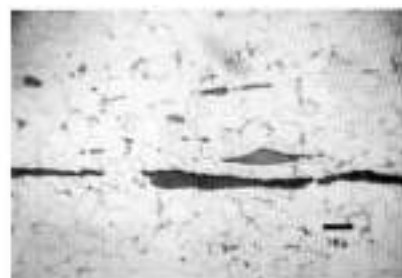
Figura 3: Inclusiones de silicatos de manganeso y sulfuros en el sentido longitudinal de cuerpo del clavo.
